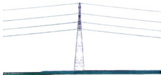
Nuage de points d'un mât électrique
